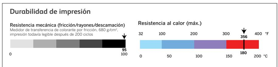
Evaluación de Videojet de rendimiento observado en la cinta Premium con configuración y receptores optimizados para impresoras.
